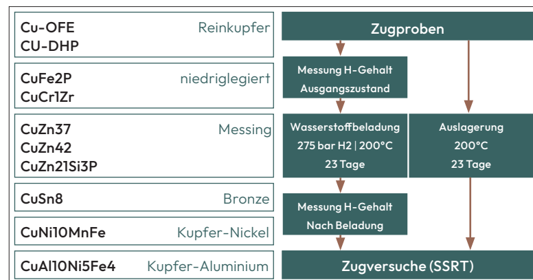
Abb. 1: Ausgewählte repräsentative Kupferwerkstoffe und Testparameter.
